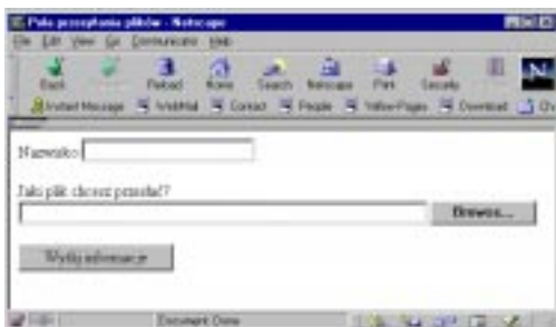
Rys. 11.36. Definiując pole przesyłu pliku tworzysz zarówno pole, w którym użytkownik może wprowadzić ścieżkę dostępu i nazwę pliku, jak i przycisk Przeglądaj (tak by gość mógł wykorzystać okno dialogowe Otwórz)
