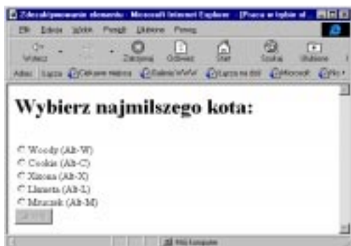
Rys. 11.60. W przykładzie przycisk Głosuj jest wycieniowany, ponieważ użytkownik nie wybrał jeszcze żadnego przycisku radiowego. Do uaktywnienia przycisku dostarczającego niezbędny jest skrypt
