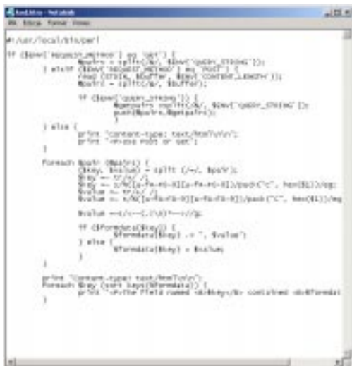
Rys. 11.7. Oto jedna z wersji niesłychanie istotnego skryptu służącego do przetwarzania danych przesyłanych z formularza. Cały kod skryptu jest istotny, może za wyjątkiem ostatnich czterech linijek, które służą do wyświetlania nadesłanych informacji w postaci prostej strony WWW
