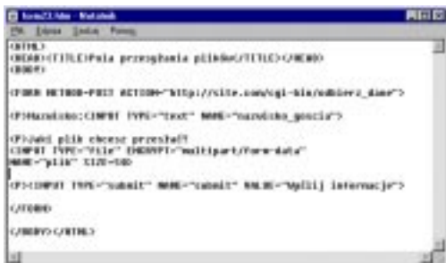
Rys. 11.35. Aby umożliwić użytkownikowi przesyłanie plików, trzeba spełnić dwa zasadnicze warunki. Po pierwsze, użyć metody POST w znaczniku FORM. Po drugie, nie zapomnieć o określeniu ENCTYPE w znaczniku INPUT
