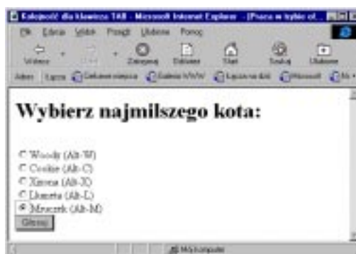
Rys. 11.58. Po naciśnięciu klawisza skrótu (w przykładzie Alt-M), wybrany i zaznaczony zostanie przycisk radiowy Mruczek. W przypadku pola tekstowego, czy też bloku tekstu, kursor zostanie przesunięty do pola, a gość będzie mógł wprowadzić tekst
